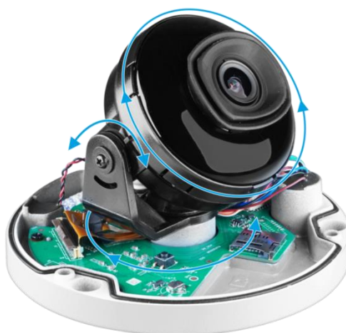
Рисунок 5.11 – Настройка направления объектива
