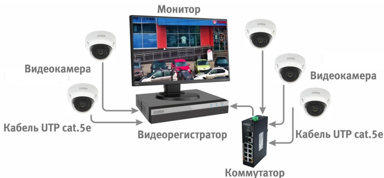
Рисунок 6.4 – Схема подключения видеокamеры к видеорегистратору
