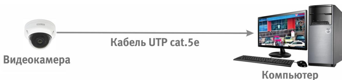
Рисунок 6.2 – Схема подключения видеокамеры к компьютеру
