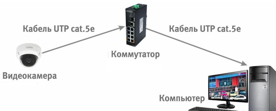
Рисунок 6.3 – Схема подключения видеокамеры к компьютеру через коммутатор
